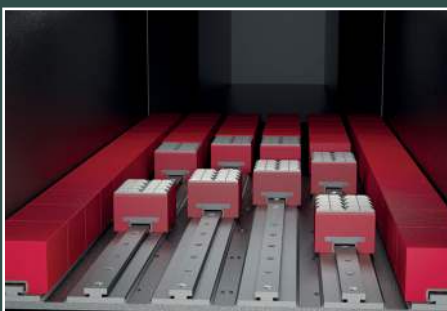
5. Kovametallimodulit asennettuna kulumiselle alttiisiin kohtiin
